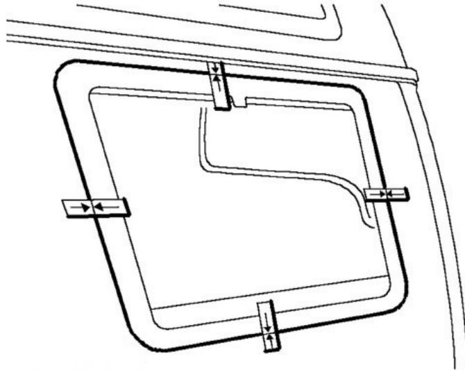
4. Nettoyez la surface de montage de la fenêtre coulissante Explore Glazing ou de la gullwing ainsi que la carrosserie avec de l'alcool. Temps de séchage / temps d'attente : 10 minutes ou plus.
